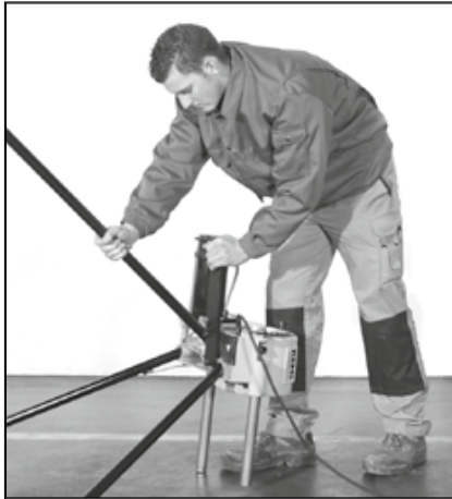
Fig. 1: RohrfüÙe einstecken Fig. 1: Inserting the tubular legs Fig. 1: Engager les pieds tubulaires Fig. 1: Infilare le gambe di supporto Fig. 1: Introducir las patas tubulares Fig. 1: Steunpoten insteken Fig. 1: Isättning av benen Fig. 1: Montering av rørben Fig. 1: Instikning af rørben Kuva 1: Putkijalkojen asennus Fig. 1: Introduzir os pés tubulares Rys. 1: MontaÙ noÙek rurkowych Obr. 1: Trubkové nohy nastrãit Obr. 1: Rúrkové nohy nastrãit' 1. ábra: Feltolní a csõlábakat Sl. 1: Utaknuti noge od cijevi Sl. 1: Umetanje noÙica cevi Slika 1: Vstavite cevno podnoÙje Fig. 1: Introducereá picioarelor tubulare Фиг. 1: Вставить трубные ножки Εικ. 1: Τοποθέτηση των σωληνωτών ποδιών Resim 1: Boru tipi ayakların takılması Фиг. 1: Постаvяне на тръбните стойки 1 pav.: Vamzdinių kojų įstatymas Att. 1: Ievietot caurules galus Joonis 1: Torujalgade sissepanek
