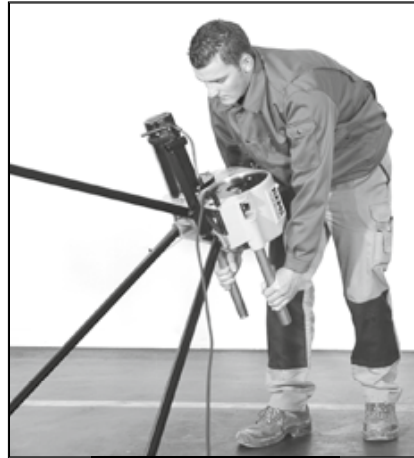
Fig. 2: Aufstellen der Maschine Fig. 2: Putting up the machine Fig. 2: Pose de la machine Fig. 2: Raddrizzamento della macchina Fig. 2: Instalación de la máquina Fig. 2: Plaatsen van de machine Fig. 2: Uppställning av maskinen Fig. 2: Opstilling af maskinen Fig. 2: Opstilling af maskinen Fig. 2: Opstilling af maskinen Kuva 2: Koneen pystytys Fig. 2: Instalação da máquina Rys. 2: Ustawianie maszyny Obr. 2: Stroj postavít Obr. 2: Stroj postavít' 2. ábra: Felállítáni a gépet Sl. 2: Postavljanje stroja Sl. 2: Postavljanje maÙine Slika 2: Postavitev stroja Fig. 2: Amplasarea maÙinii Фиг. 2: Установка станка Εικ. 2: Τοποθέτηση της μηχανής Resim 2: Makinenin kurulumu Фиг. 2: МонтаÙ на машината 2 pav.: Staklių pastatymas Att. 2: MaÙinas uzstãdãšana Joonis 2: Masina ülespanek
